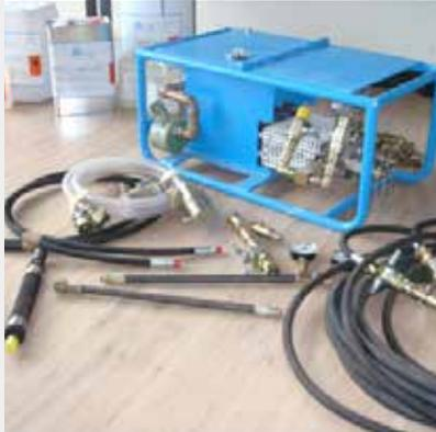
Bomba de injeção de metacrilato pneumática bicomponente
