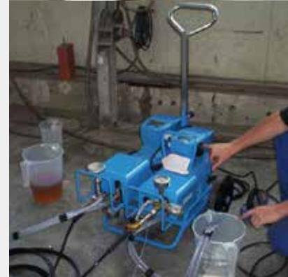
Bomba de injeção elétrica monocomponente
